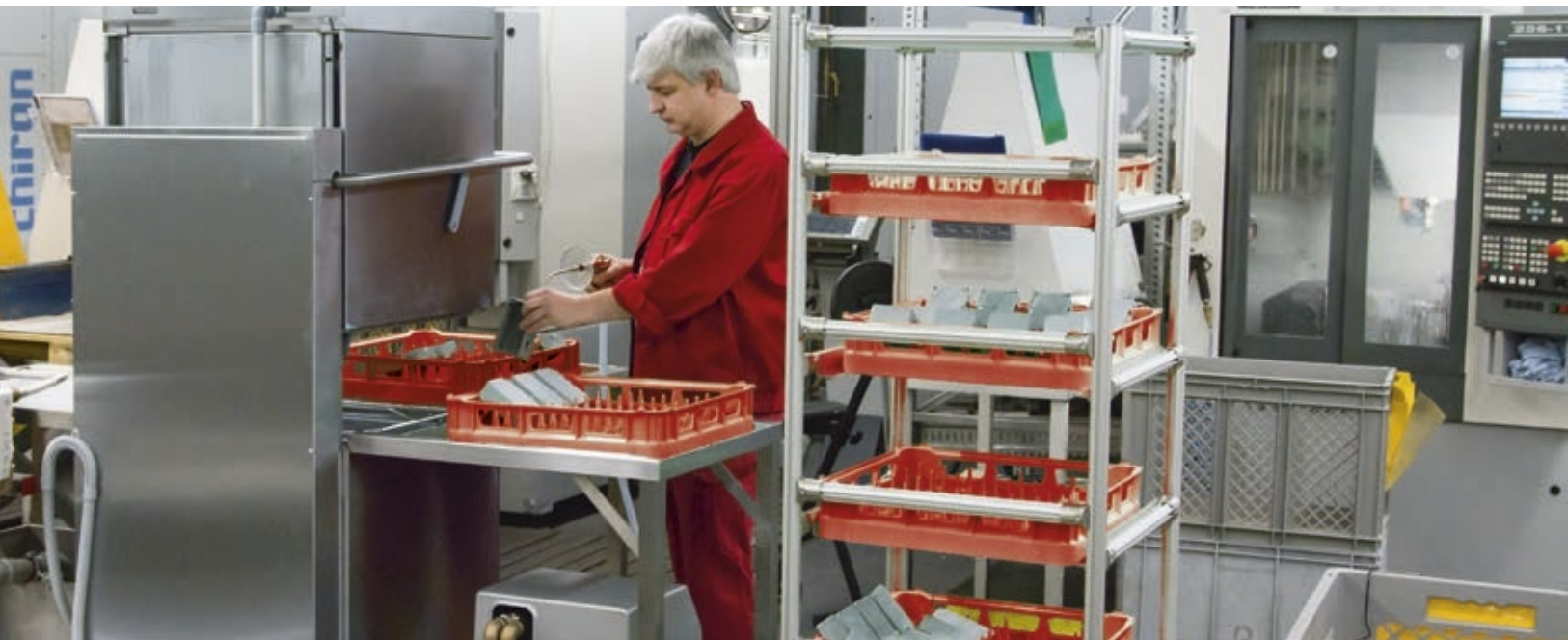
Bei der Montage von Lineareinheiten reduzieren gezielte Zwischenprüfungen aufwendige Nacharbeiten (oben). | Reinigen der Bauteile parallel zur mechanischen Bearbeitung. Optimierung der Auftragsdurchlaufzeit durch Reduzierung der Prozesskette bei gleichzeitiger Erhöhung der Produktivität.
