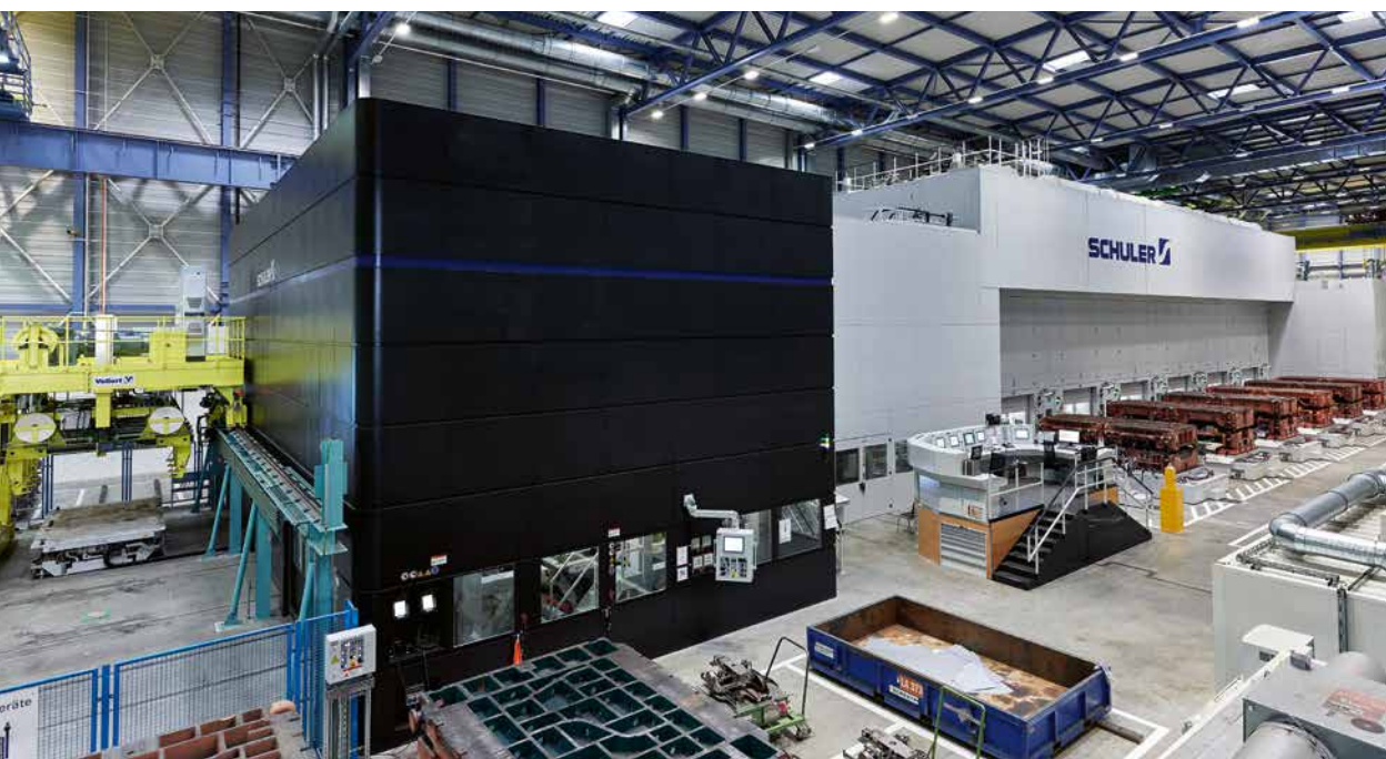
Schuler fertigt ganze Pressenlinien, die Presskräfte von bis zu 10000 t erreichen können. Bild: Schuler AG
